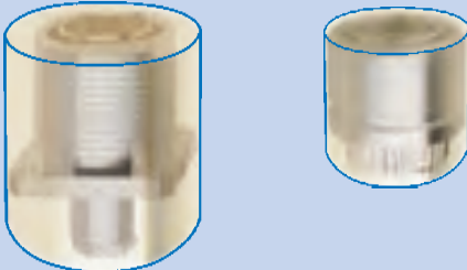
Material consumption for flange and Press-in type Materialverbrauch bei Flansch und Press-in Typ
